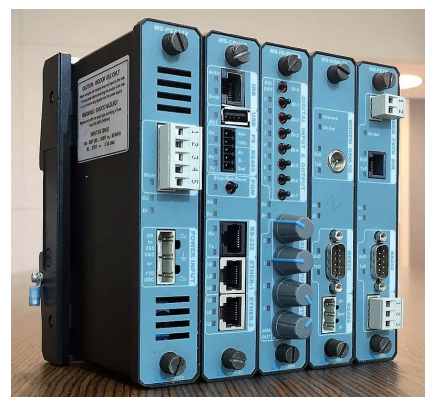
Figura 1.7- Unidade terminal remota (fonte: Wikipedia )
