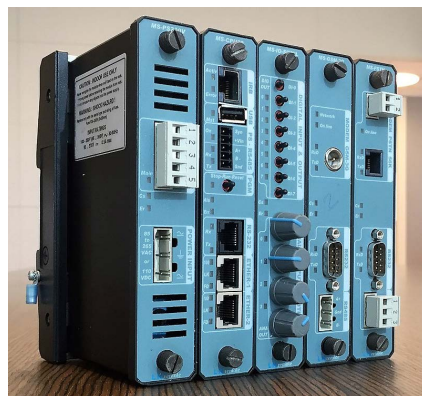
Εικόνα 1.7- Απομακρυσμένη Τερματική Μονάδα (Πηγή: Wikipedia)
